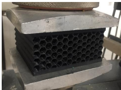
Figura 3 - Ensaio de compressão de dissipador de energia com estrutura honeycomb em PETg
