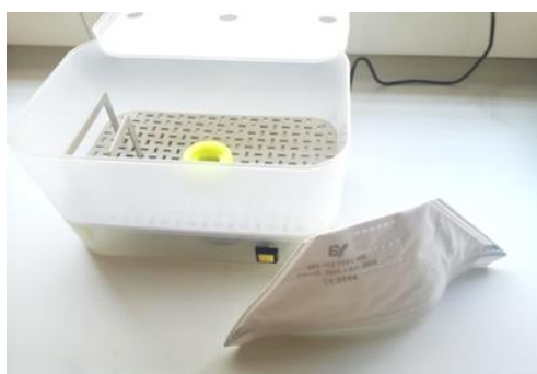
Figura 2 – Versão portátil de baixo custo da câmara de descontaminação capaz de descontaminar até 4 máscaras N95. A versão miniaturizada do gerador de vapor de peróxido de hidrogênio está integrada na câmara.
