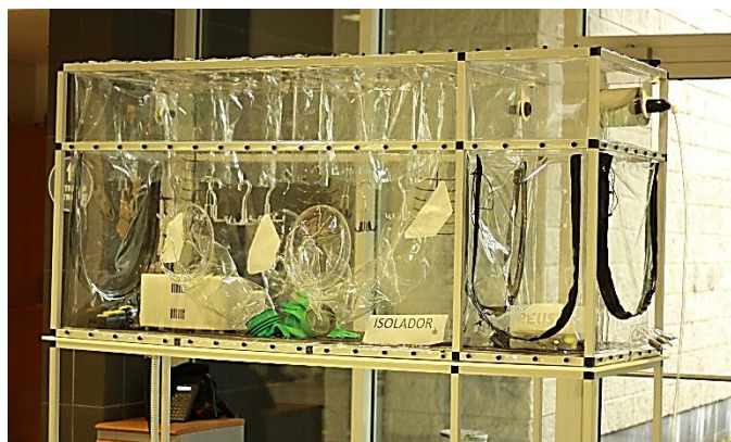
Figura 1 – Câmara de descontaminação portátil onde a Delox Box é usado para gerar um vapor descontaminante de elevada eficiência.
