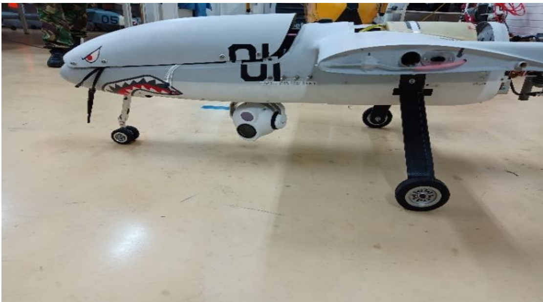
Figura 3 – UAS Alfa Extended equipada com sensor ótico do espectro visível e infravermelhos
