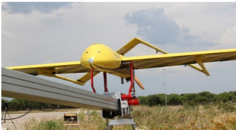
Figura 2 – UAS30 P1 Configurado para operação tática com descolagem por meio de catapulta e aterragem em rede
